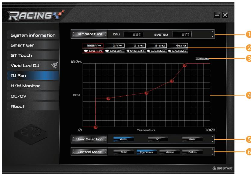
1. 温度(Temperature)：显示当前CPU和系统温度。
