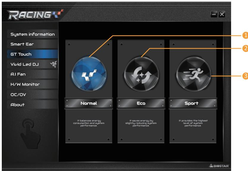
1. 常规模式(Normal) : 自动平衡系统性能与电源消耗。
